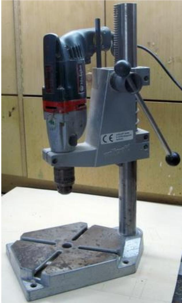
**Ständerbohrmaschine** (Stabile Handbohrmaschine an einfachen Bohrständer montiert).
